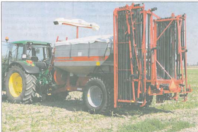
I transportstilling fylder Kongskildes Wing Jet ikke mere end tre meter i bredden. Her er maskinens Tronic system koblet sammen med N-sensor udstyr fra Yara. (Fotos: Bøje Østerlund)
