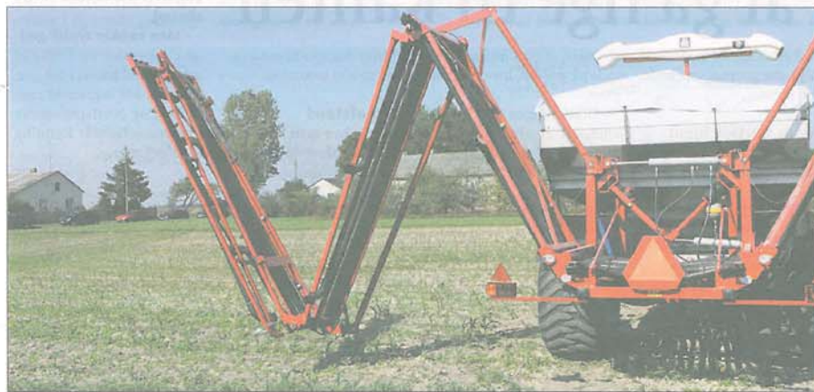
Den 24 meter brede bom på Kongskildes Wing Jet gødningsspreder foldes hurtigt sammen fra traktorens førersæde.
